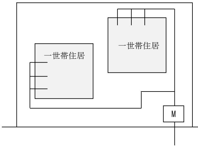
○給水管及びメータ口径は、給水栓の吐出量及び数量、同時使用率等を考慮して決定するが、台所、風呂、トイレ等が世帯ごとにあるため、 $\phi 20$ となり得る。
