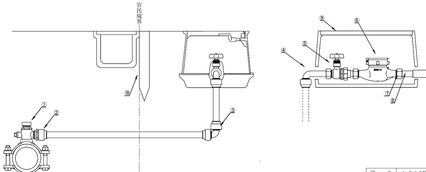
図 名 メータ・止水栓設置標準図  $\phi$  13~25
