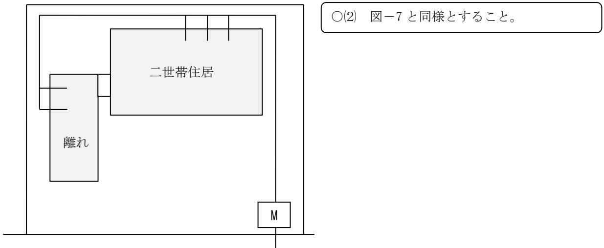
図-11 給水管が1か所でメータを2個とする場合
